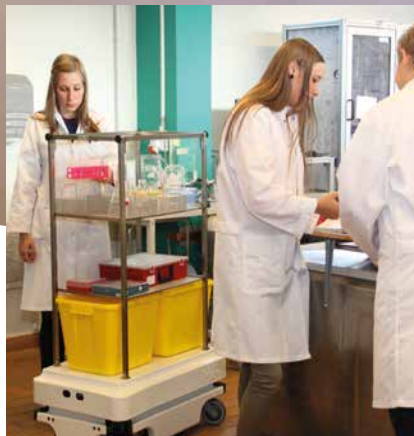
MiR kan monteres med forskellige modul-løsninger, alt efter hvilken type varer eller materialer, den skal transportere.
