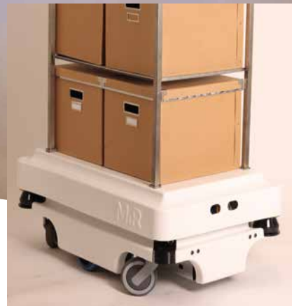
MiR100 kan løfte op til 100 kg og bremser og undviger automatisk for dynamiske ændringer.
